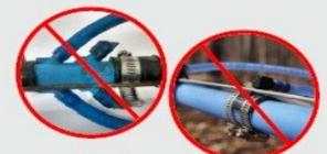
2. Séparer les tuyaux maîtres des tubes de dimension 5/16. Les raccords et chalumeaux en plastique connectés à la tubulure sont acceptés.
