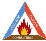
Dans notre cas, le fait de mouiller le chiffon (combustible) imbibé d'huile de lin (comburant) permet de réduire la chaleur, élément indispensable à la combustion.
